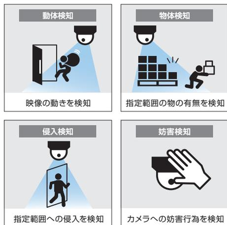
スマート検知に対応したカメラは、映像内の動きを検知してアラームを送る機能「動体検知」はもちろん、その他にも高度な検知機能を搭載しています。
