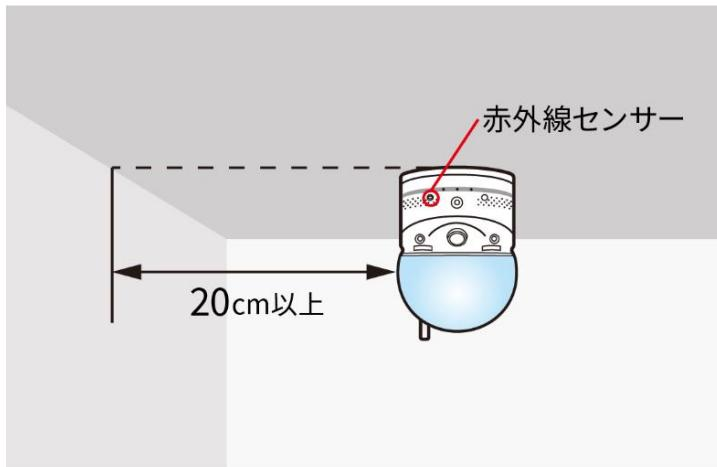
IP カメラと壁の距離が 20cm 以下 の場合は壁に対して 20 度以上の角度をつけて設置してください。
