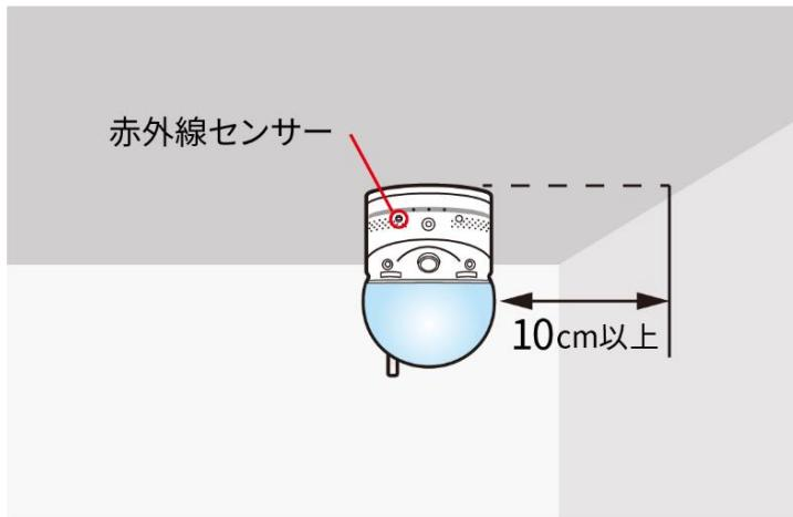
IP カメラと壁の距離が 10cm 以下 の場合は壁に対して 10 度以上の角度をつけて設置してください。
